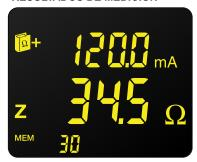
Muestra la corriente de fuga y la impedancia del bucle en la frecuencia de prueba
