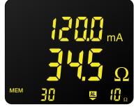
Indica el umbral de la alarma de corriente o tensión junto con la dirección de impedancia
