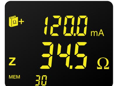
Exibe a corrente de fuga e o loop de impedância na frequência de teste
